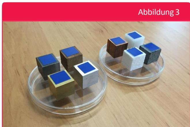
↑ Versuchsaufbau für die Wärmeleitfähigkeit
