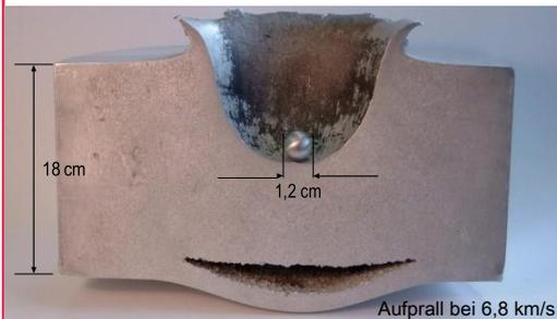
Sieh dir an, was in einem Test passiert ist, bei dem Raumfahrzeug-Material mit hoher Geschwindigkeit getroffen wurde (Abbildung links). Das Orion Service Modul hat eine starke Struktur, die aus vielen Lagen besteht, welche solche Schäden verringern können.
