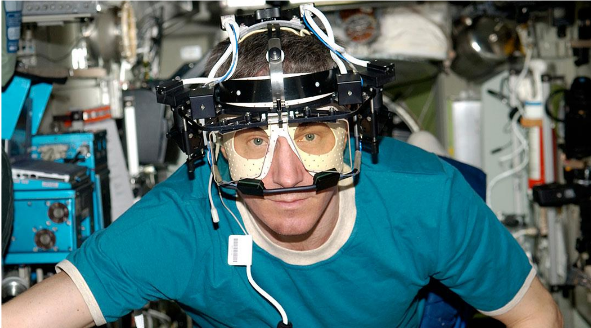
Bild 1: Bevor das C-ETD zur Diagnose von Gleichgewichtstörungen eingesetzt wurde, wurde es von Astronauten im All getestet, um so auch ihre Gleichgewichtsprobleme zu verstehen.
