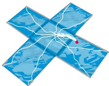
Ein Kreuzfallschirm ist einfacher zu nähen als ein Rundkappenfallschirm, weil die Form einfacher von Hand hergestellt werden kann.
