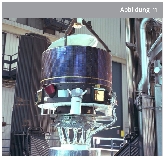
↑ Giotto bereit für den solaren Simulationstest. © ESA
