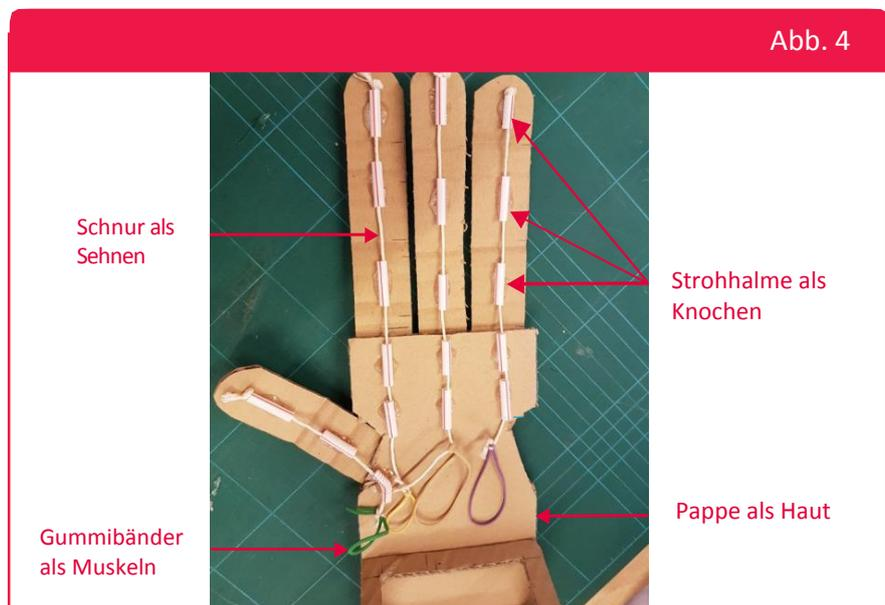
↑ Bild der fertigen bionischen Hand (Unterseite).
