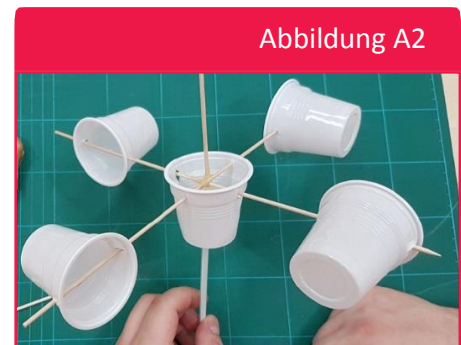
↑ Windmesser zur Messung der Windgeschwindigkeit.
