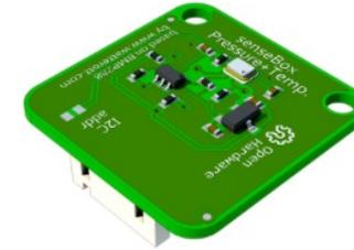
Anschluss: I2C/Wire Ports
