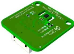
Anschluss: I2C/Wire Ports
